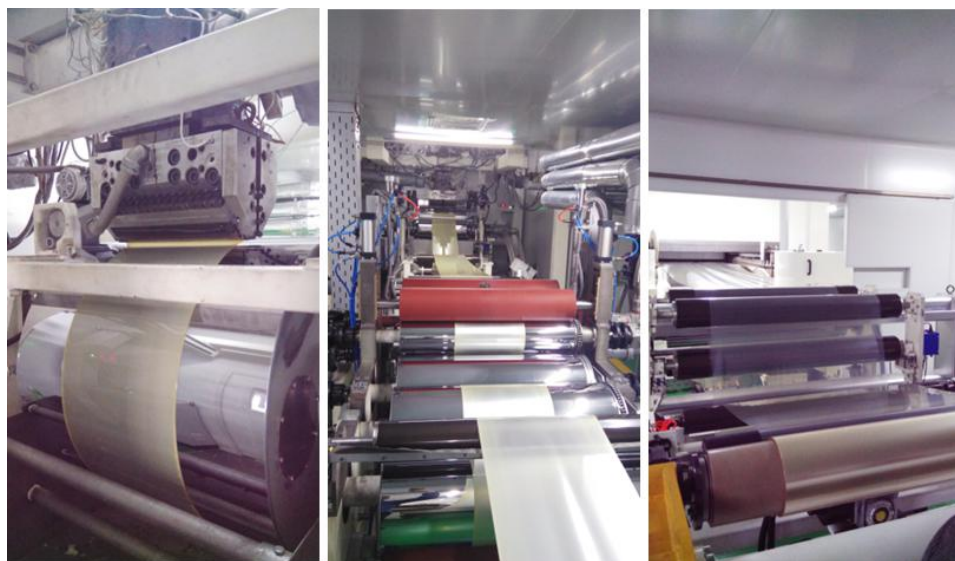
微纳层叠双向拉伸薄膜成型设备
