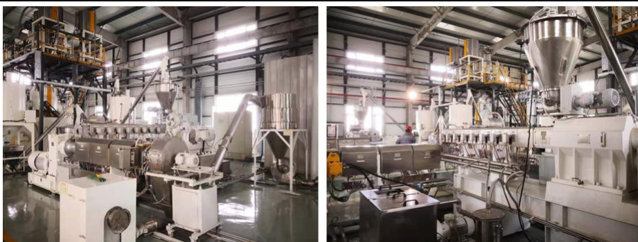
微纳层叠高性能聚氯乙烯制备装置
